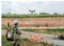
ドローンによる測量の実施
